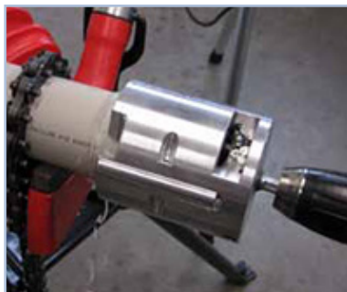
Skrap utsiden av røret.
