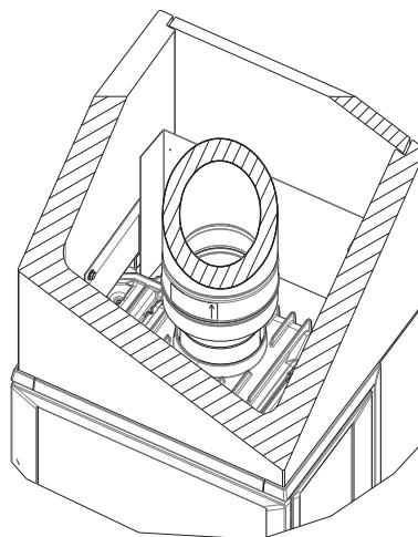
Montieren Sie anschließend den Stahlschornstein gemäß den Herstelleranweisungen.
