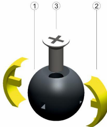
3-Wege L-Bohrung 3-ways L-bore 3-vie sfera L "L"
