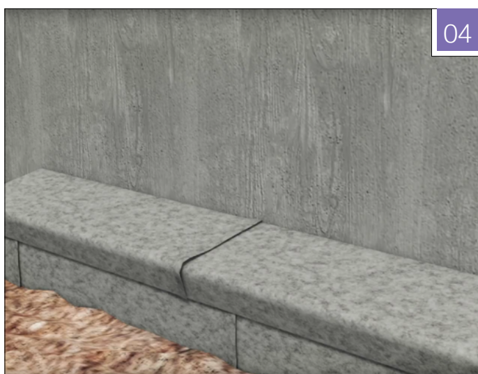
Fig. 04: Har muren utstikkende såle, kapp til og isoler denne med Jackon Thermodren®.
