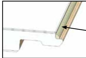
12) Påfør nok Wetwall SEAL/Casco Aqua Seal fugemasse til at det typer ut i hele skjøtens lengde.
