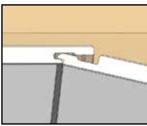
13) Klikk platene sammen. Spray på Wetwall CLEAN, fjern overskytende fugemasse med Smartpanel Wetwall fugeklosser. Tørk av med Smartpanel Wetwall WIPES.
