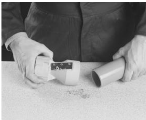
Fase røret. Ta vekk grader på innsiden og utsiden av røret.
