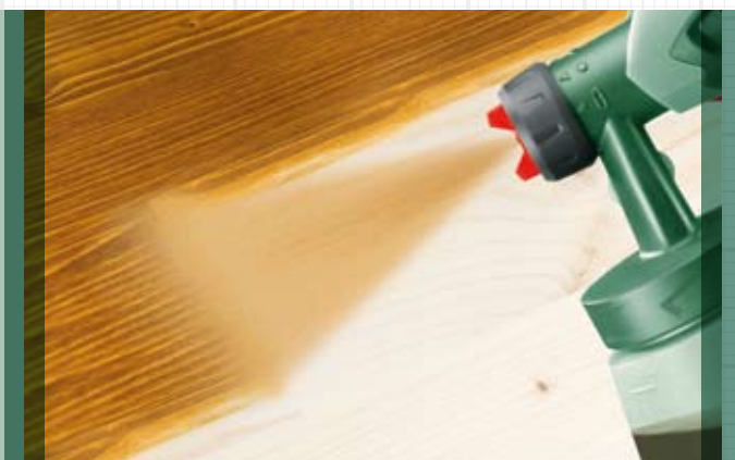
6. Lasere overflaten: Les først tipsene fra produsenten angående bearbeidelse og sikkerhet nøye. Arbeid i et godt ventilert rom der du ikke røyker, spiser eller drikker.
