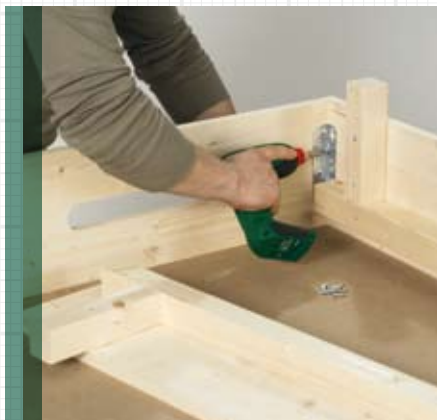
2. Understell: Montere føtter og planker
