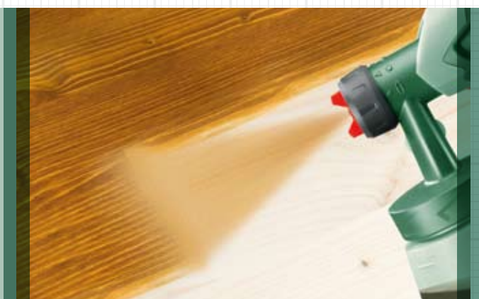
7. Lasere overflaten: Les først tipsene fra produsenten angående bearbeidelse og sikkerhet nøye. Arbeid i et godt ventilert rom der du ikke røyker, spiser eller drikker.
