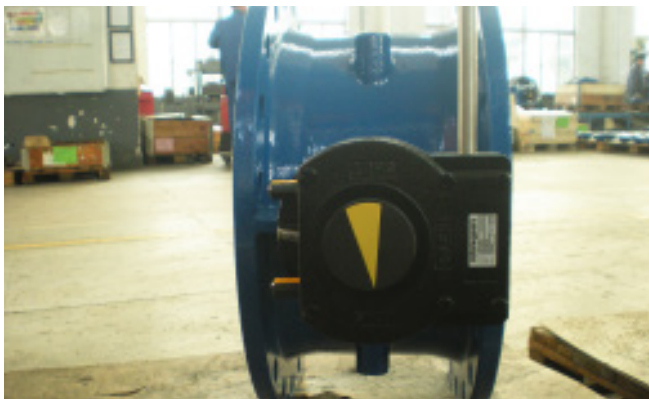
Kontroll av stillingsindikator – steg 4
