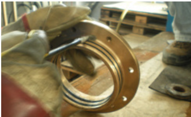
Montering og smøring av O-ringer steg3
