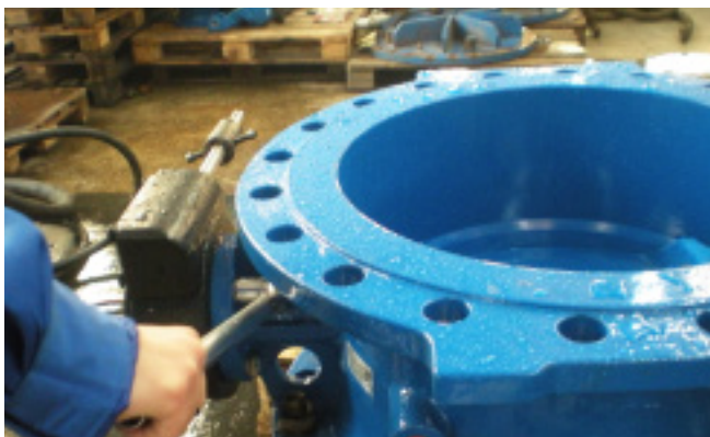
Montering av girboks – steg 5
