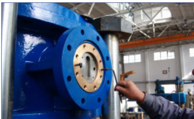
Utskifting av O-ring - trinn 2
