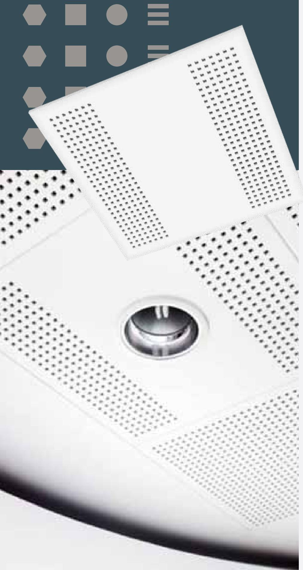
Produktprogrammet for Gyptone Quattro 22 omfatter ett standardmønster med kvadratiske hull. Platene framstilles med fire forskjellige kantutforminger tilpasset både synlige og skjulte opphangssystemer. Platene har gjennomgående hull som i kombinasjon med den bakenforliggende akustikkfilten, gir gode akustiske egenskaper.
