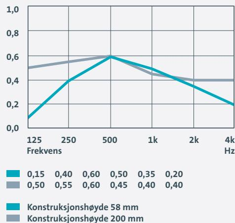
Målingene oppfyller kravene til ISO 354. Samtlige målinger er utført på standard plater med pålimt akustikkfilt på baksiden. Konstruksjonshøyden angir avstanden mellom himlingens og bjelkelagets underkanter. Platenes lydabsorpsjon påvirkes av konstruksjonshøyden og evt. bakenforliggende mineralull.
