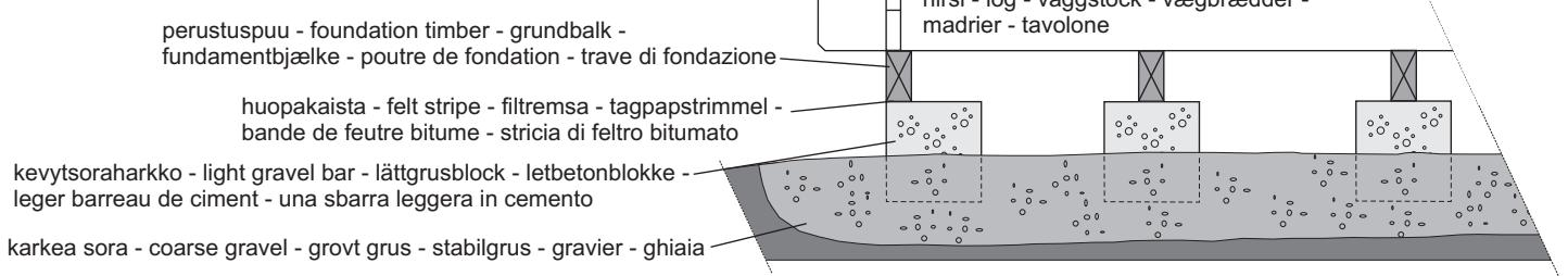
**4. Hirsien asennussuunta, perustuspuiden asettelu ja lattian kiinnitys - The assembling direction of logs, foundation beams and assembling of the floor - Monteringsdirektion av väggtimren, grundbalkarna och montering av golvet - Vægbrædderne, fundamentbjælkerne og montering af gulvet - La pose des solives et la fixation du plancher - La posa delle travi di fondazione**
