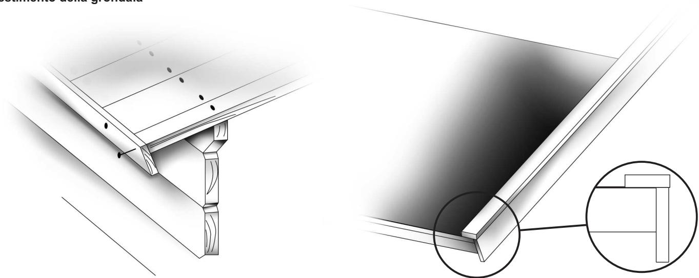
**15. Myrskylistat 19 mm mökeissä - Storm battens in 19 mm cabins - Stormlisterna på 19 mm stugor -
