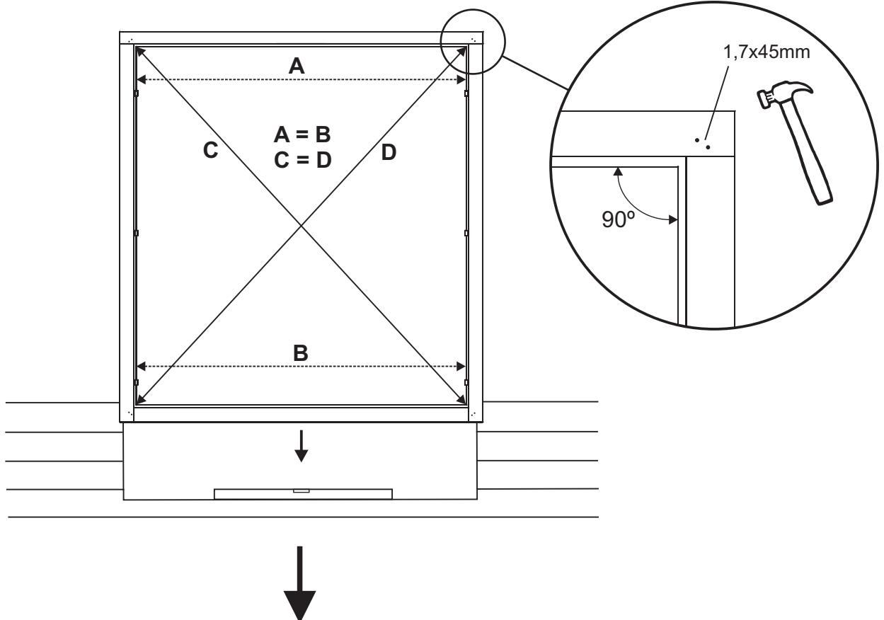
**8b. Parioven asentaminen - Assembling the double door - Montering av dubbeldörren - Montering af fløjdøren -
