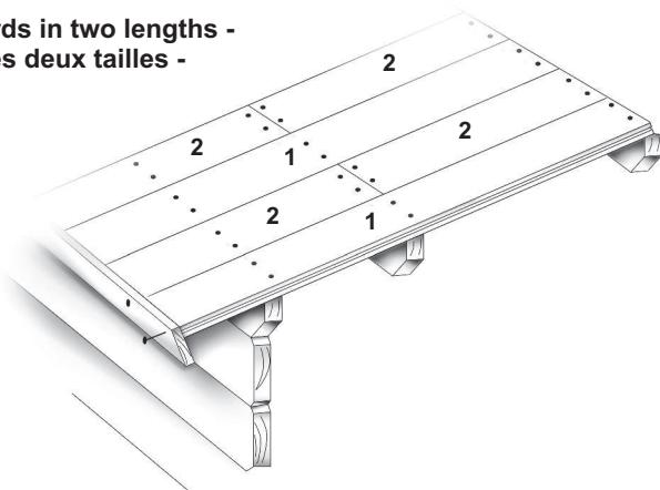
12. Räystäslautojen asentaminen - Assembling the fascia boards - Montering av gavel- och takfotsbrädorna samt
