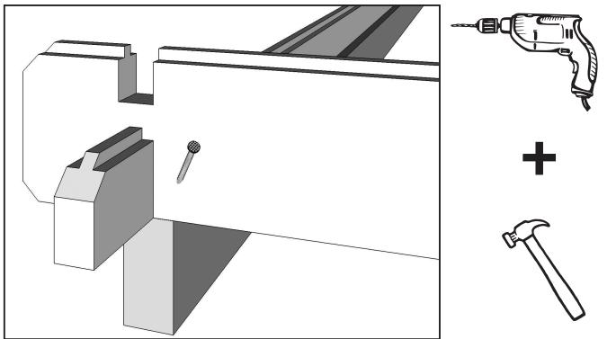
**7. Oven asentaminen - Assembling the door - Montering av dörren - Montering af døren - La pose de la porte - La posa della porta**
