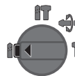
Положення для свердлення без удару в деревині, металі, кераміці і пластмасі, а також для закручування гвинтів
