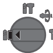
Позиција за Дупчење без удари во дрво, метал, керамика и пластика како и за зашрафување/одвртување
