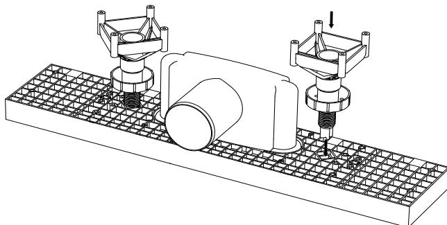
Trykk Purus støtteben på sluket og juster til ønsket høyde. Lengdene 900-1200 har fire hull for feste av Purus støtteben, benytt kun hullene som er ytterst.
