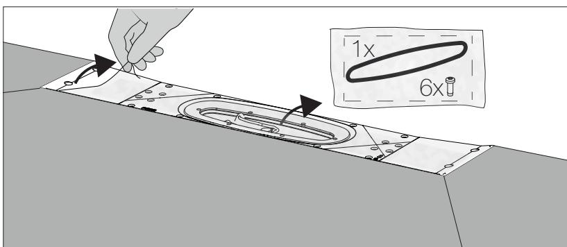
Fjern beskyttelsesfolien, løft opp klemringen og plukk ut posen som inneholder 1 stk. o-ring og 6 stk PT skruer for klemring.
