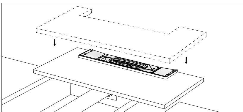
Legg på en 22 mm sponplate med åpning tilpasset slukets mål.
