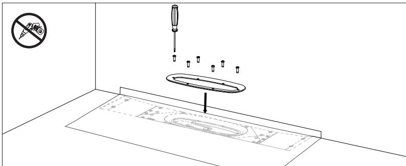
Membran med tilhørende slukmansjett legges i.h.t membranleverandøren montiringsanvisning. I kombinasjon av gulvsluk og tettesjikt skal det brukes en membran i samhørighet med de ulike sluktypene som har en SINTEF Teknisk Godkjenning.
