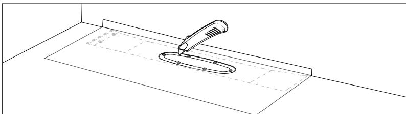
Skjær med en kniv langs innsiden av klemringen slik at ingen membran stikker ut.
