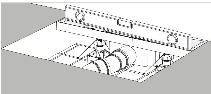
Plasser sluket og koble til avløpsrører. Kontroller at sluket er i vater.
