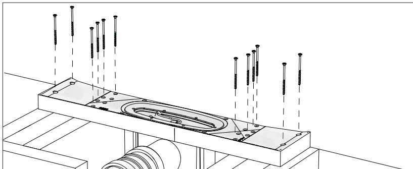
Sluket monteres direkte på trebjelkelaget med følgende treskruer. Toppkant av sluket skal være i nivå med ferdig gulv, dvs på nivå med slukmansjett. Sluket monteres direkte mot "rå" vegg.
