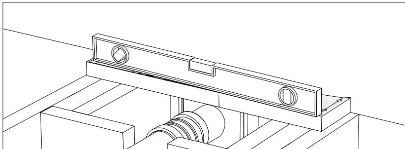
Kontroller at sluket sitter vannrett og koble til avløpsrøret
