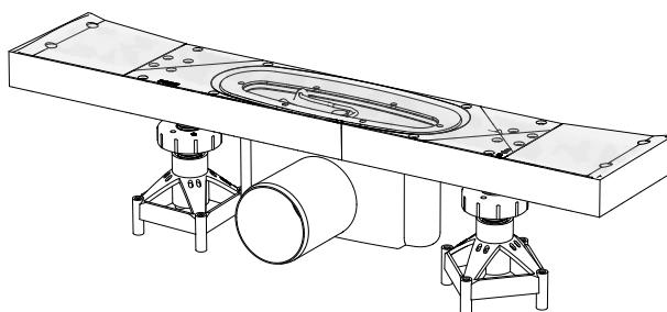
Beskyttelsefolien skal ikke fjernes under monteringen.
