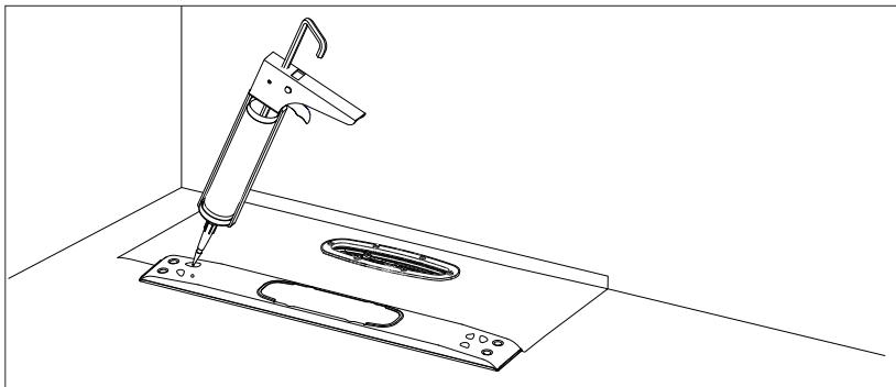
Rammen punktlimes fast på membranen med montagelim eller festes med fliselimet. Om det behøves kan rammen justeres i høyden ved bruk av fliselimet.
