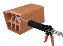
OBS: Trykk først ut klebemørtelen til den får en jevn farge. Trykk deretter inn mørtel i hullet
