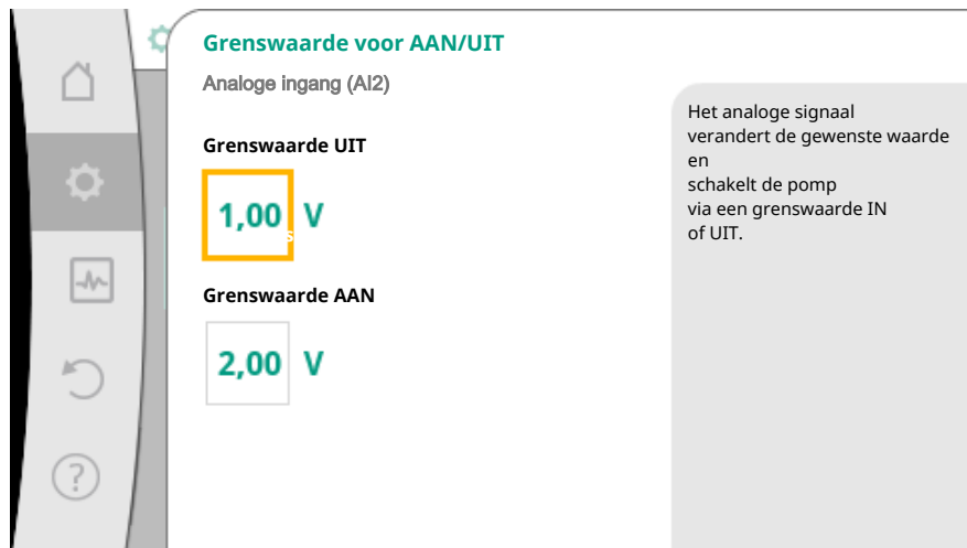
Fig. 74: Grenswaarden voor AAN/UIT-besturing via analoge signalen
