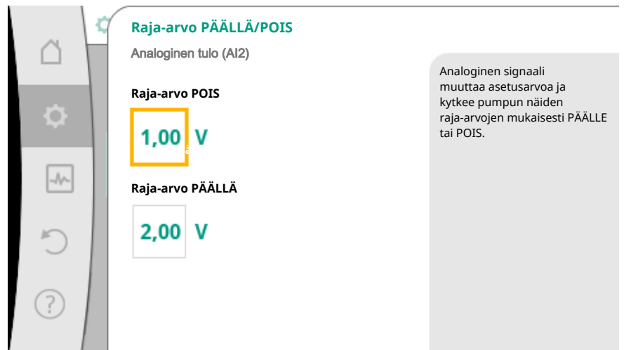
Fig. 74: Raja-arvot PÄÄLLE-/POIS-ohjaukseen analogisten signaalien kautta
