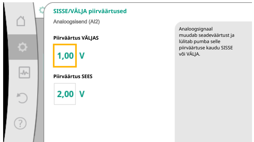
Fig. 74: SISSE/VÄLJA juhtimise piirväärtused analoogsignaali kaudu
