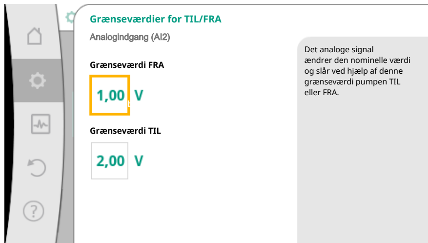
Fig. 74: Grænseværdier til TIL/FRA-styring via analoge signaler
