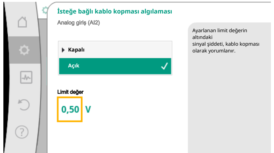
Fig. 72: Limit değer kablo kopması
