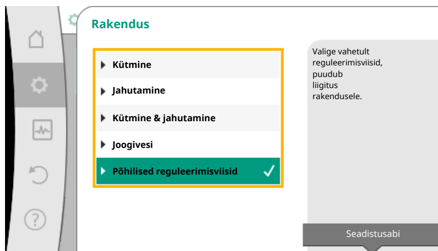
Fig. 50: „Põhilised reguleerimisviisid“ rakendusvalik
