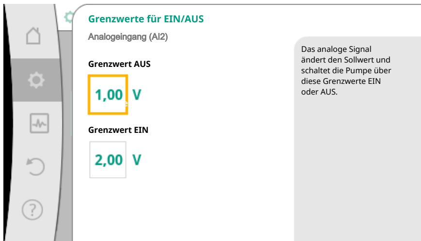
Fig. 74: Grenzwerte zur EIN/AUS-Steuerung über Analogsignale
