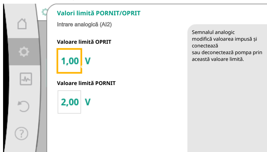
Fig. 74: Valori limită pentru comandă PORNIT/OPRIT prin semnale analogice
