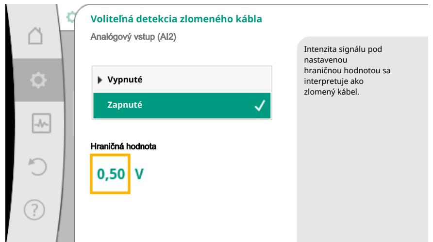
Fig. 72: Hraničná hodnota zlomeného kábla
