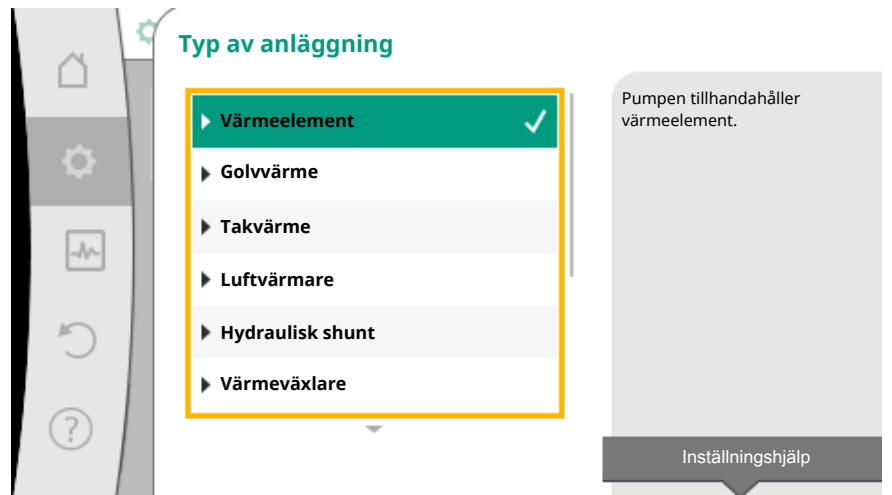
Fig. 47: Exempel, systemtypen "Värmeelement"
