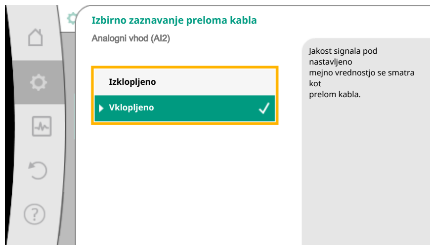
Fig. 71: Izbirno zaznavanje preloma kabla
