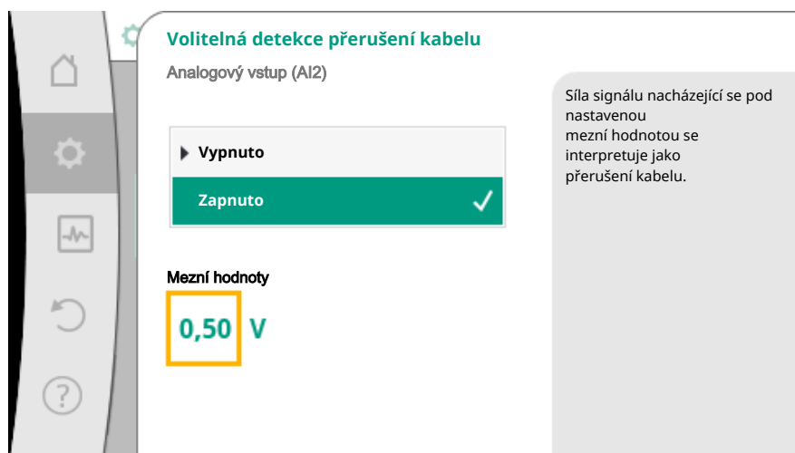
Fig. 72: Mezní hodnota – přerušení kabelu
