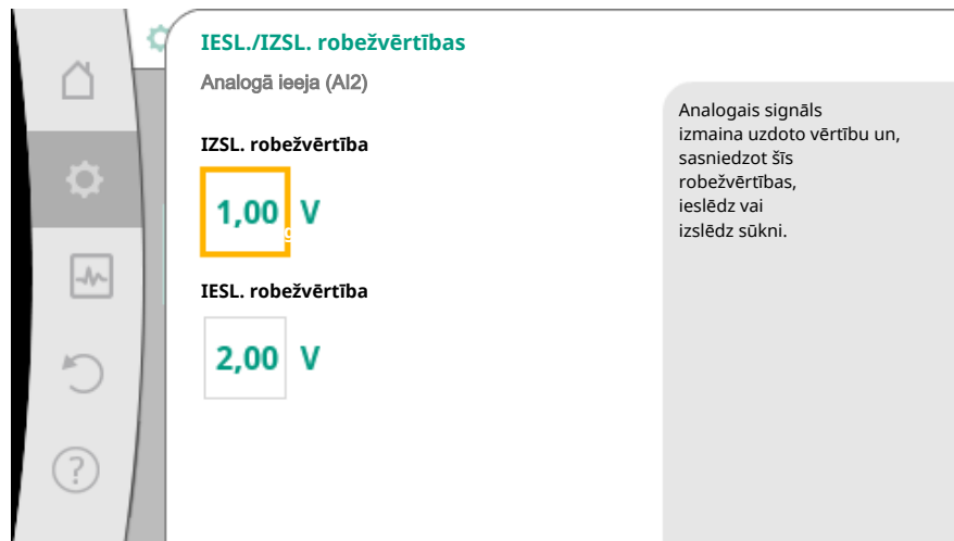
Fig. 74: IESL./IZSL. vadības robežvērtības, izmantojot analogos signālus
