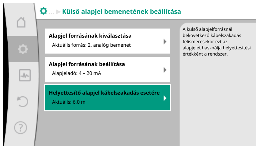
Fig. 77: Helyettesítő alapjel kábelszakadás esetére
