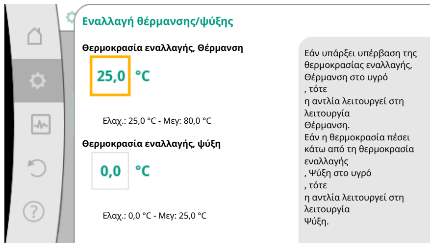
Fig. 57: Εναλλαγή θέρμανση/ψύξη_Θερμοκρασίες εναλλαγής
