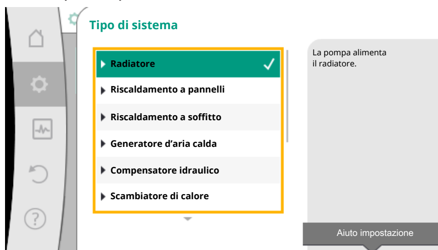
Fig. 47: Esempio tipo di sistema “Radiatore”
