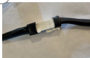
Sitter kabel till trådlös brygga installerad där kabel 2 ska kopplas flyttas kabeln till bryggan till kontakt 3. I annat fall ska kontakten vara tom.
