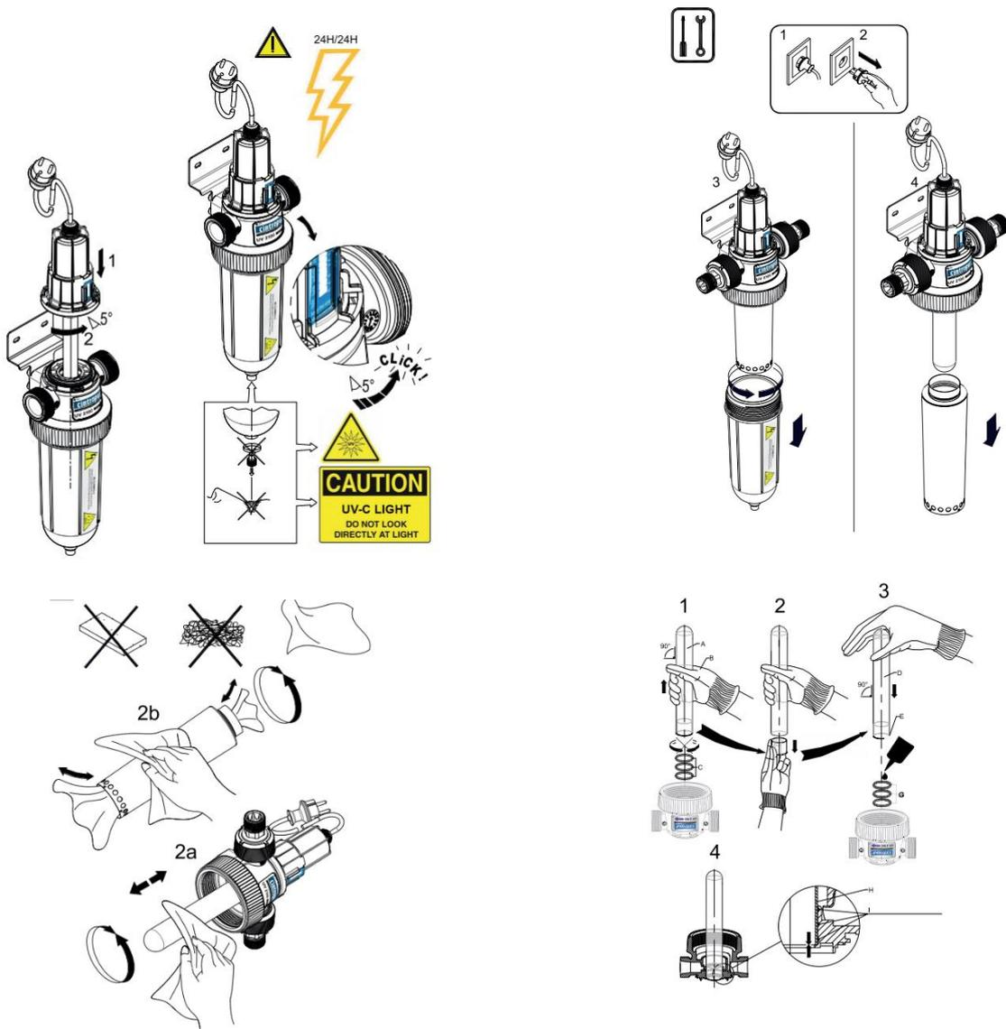
Kvartsrøret kan bli skittent eller ha kalkavleiringer. I slikt tilfellet må du ta ut røret å rengjøre det med sitronsyre (eddik, oppløsningsmiddel mot kalk). Produktet som brukes må ikke være slipende.
