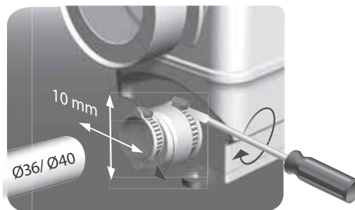
Fig. 35 Højde- og sideopretning mulig ved brug af Ø36/40 tilgangsør
