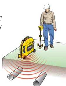
Induktion af signal til lokalisering af installationer
