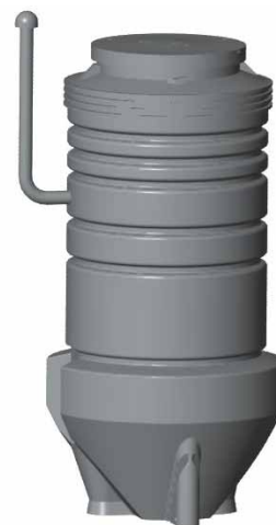
Fig. 15 Brønd med udluftningsrør
