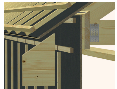
Overgang vegg/tak med løst utstikk
