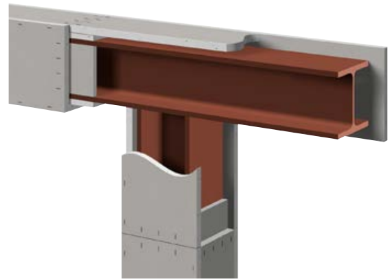
Bjelke kledd på 3 sider, understøttet av søyle kledd på 4 sider.
