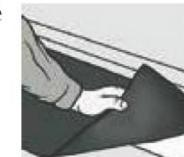
**SV:** Om underlaget är betong måste en fuktspärre placeras under tröskeln, t ex. tjärpapp.
