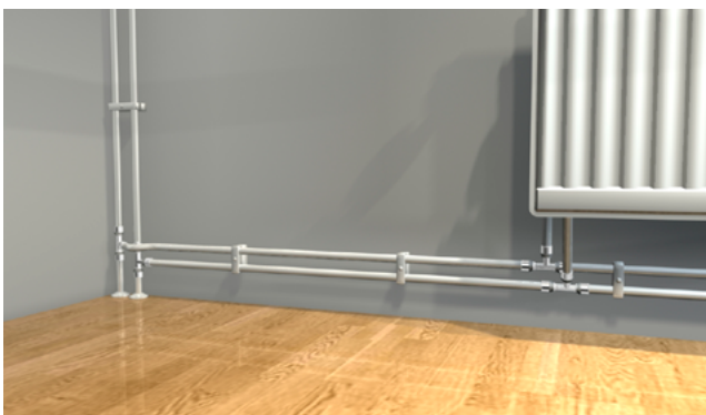
Eksempel på fiksering ved synlig forlegning.
