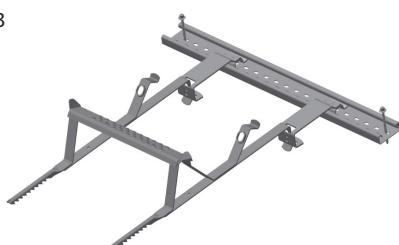
**NB! Stigetrinn TR TV-35 T har et annet koblingssystem; T-låsen føres inn i nøkkelsporet som vist på fig. 5**
