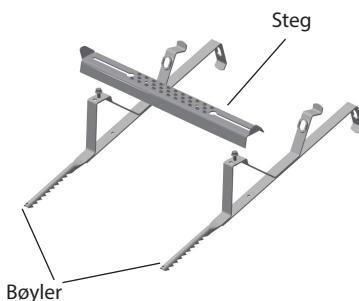
Normalt sett kopplas flera taksteg samman. På det översta takstegen kopplas infästning och infästningsskena. Om et fristående taksteg ska monteras måste det monteras med infästning och infästningsskena. Du bör använda skruvdrill vid montering.
