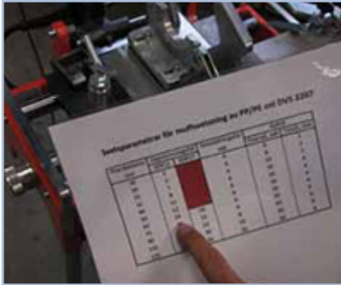
Kontroller sveiseparametrene iht. DVS 2207
