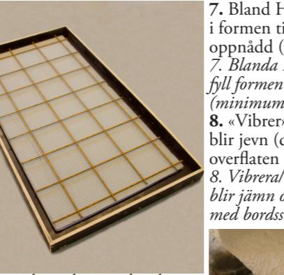
**4.** Kapp til en plate med isolasjonsmateriale og fest denne til bunnplaten, la det være 2-3 cm plass rundt kantene.
