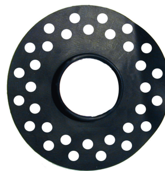
3. Tre mansjett over boksforlenger, Påse at O-ringen vender ut, og skyv denne helt inn til vegg slik at mansjet ligger i den påførte membran.
