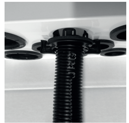
3. Monter klipset igjennom ett av hullene i bunnen av skapet.
