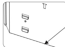
Il y a deux petits rails triangulaires au bas du panneau arrière. Placez l'appareil sur les rails et appuyez sur l'appareil en position verticale contre les lèvres sur le dessus du support.
