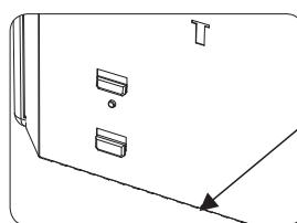
В долната част на задната плоча има две малки триъгълни релси. Поставете отоплителния уред на релсите и го бутнете към маншетите върху конзолата във вертикално положение.
