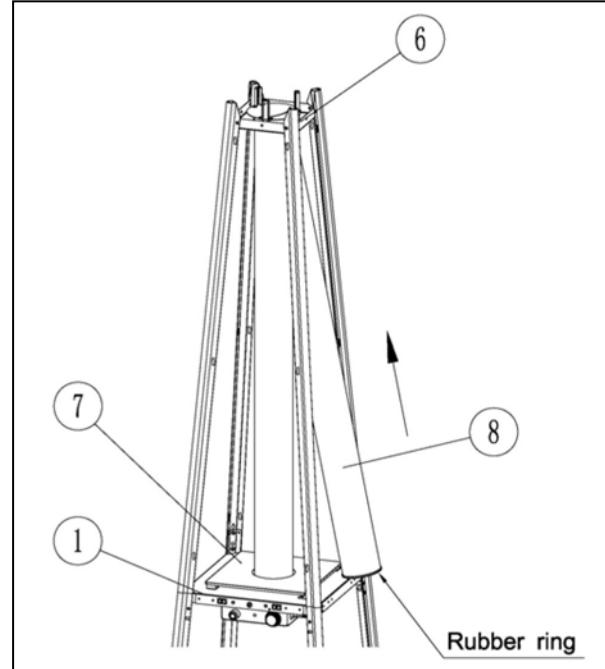
**6. Før glassrøret (8) forsiktig opp gjennom senterhullet i den øvre platen (6). Pass på at gummiringen er festet på den nedre enden av glassrøret (8). Plaser glassrøret (8) gjennom hullet til plate dekselet (7) på den midtre platen (1), sjekk og forsikre deg om at glassrøret (8) dekker hullet i den midtre platen (1)**
