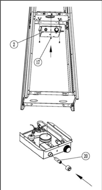
**5. Sett inn et AA batteri (20) i kontroll boksen, deretter festes kontrollboksen (2) på undersiden av den midtre platen (1) med skruer (17)**
