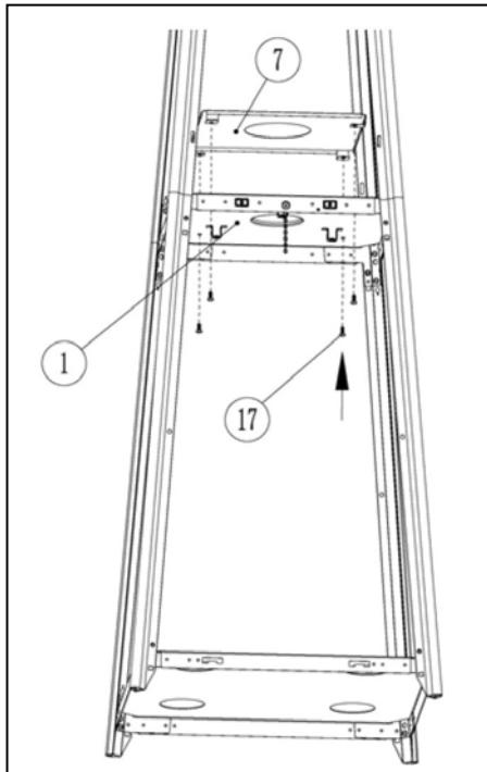
**11. Montera locket (7) på mellansektionen (1) med skruvarna(17).**
