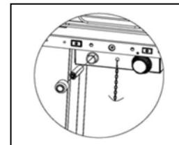
**1. Forsikre deg om at kontrollknappen er i OFF. Ventilen på gassflasken åpnes sakte.**
