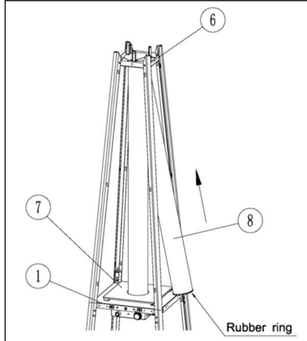
**19. Aseta lasiputki (8) huolellisesti ylälevyn (6) keskelle. Aseta kumitiiviste (rubber ring) lasiputken (8) alareunaan. Aseta lasiputken (8) alareuna suojalevyn (7) läpi siten, että se laskeutuu keskilevyn (1) päälle ja siinä olevan reunakorotuksen ulkopuolelle.**
