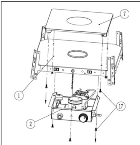
**9. Montera ur manöverboxen (2) och locket (7) från mellansektionen (1) genom att skruva ur skruvarna (17)**
