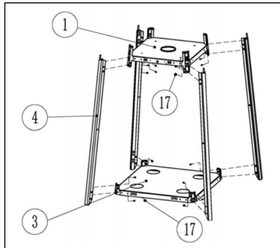
**10. Montera och fixera de fyra nedre stöden (4) till bottenplattan (3) och mellansektionen (1) med skruvarna (17)**
