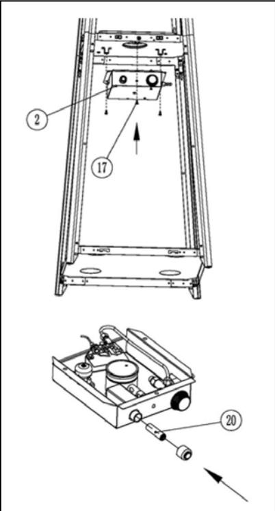
**18. Aseta AA-paristo (20) ohjausyksikön etureunassa olevan sytytimen sisään ruuvaamalla sytytimen pää auki. Pariston +napa tulee ulospäin. Asenna ohjausyksikkö (2) keskilevyn (1) alapuolelle ja kiinnitä ruuveilla (17).**
