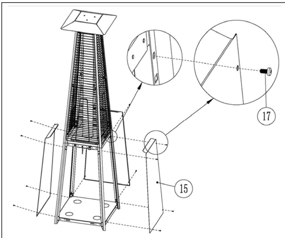
**11. Montera 3 sidopaneler (15) med skruvarna (17).**
