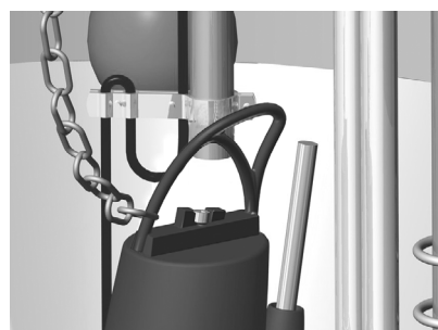
Fig. 27 Kæde monteret på pumpe
