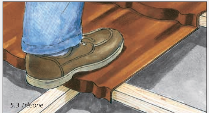
5.3 Tråskone Ved tråkk på takpannene skal foten plasseres i bølgedalen.
