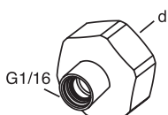
Overgangsnippel For kapillarrør med G1/16-kobling.
