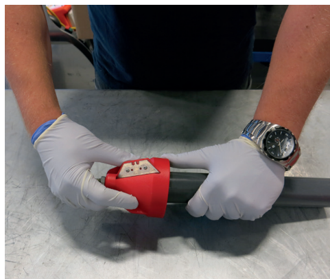
Fase røret. Ta vekk grader på innsiden og utsiden av røret.
