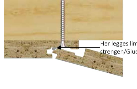
Fig. 3 Tapetsert kombilist for innvendig og utvendig hjørne / Special corner profile for exterior and interior corners
