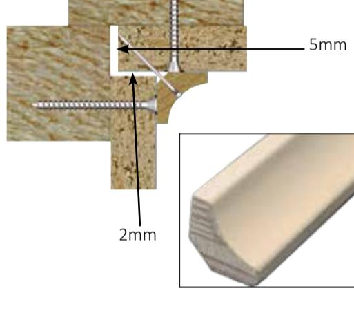
Fig. 5 Utvendig hjørnelist / Exterior corner moulding
