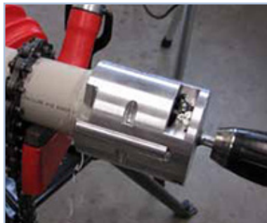
Skrap utsiden av røret.
