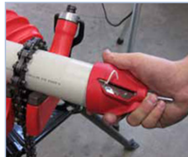
Fase enden av røret.
