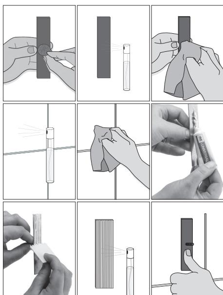
Förbehandla brickornas ytor och rengör brickor och vägg. Applicera lim på brickorna, tanda ut limmet och spraya med i.Cleaner spray på limmet. Se till att brickorna sitter dikt an vägg!
