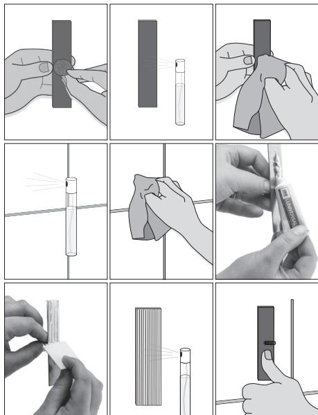
Forbehandle skivene overflater, og rengjør skiver og vegg. Påfør lim på skivene, fordelt limet og spray i.Cleaner på det. Skivene må ligge an mot veggen!
