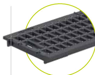
3 DUKTILT STØPEJERN GITERRIST Maskevidde 15/28 mm, klasse C 250
