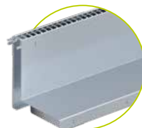
4 SPALTETOPP Spaltevidde 12,5 mm/110 mm Spaltehøyde 18/110 mm Galvanisert eller rustfri stål V2A klasse C 250
