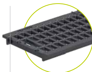
3 DUKTILT STØPEJERN GITERRIST Maskevidde 15/28 mm, klasse C 250
