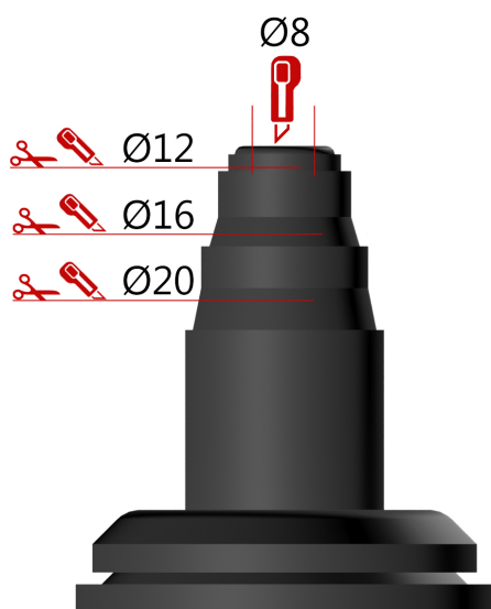
Kapping av rørgjennomføring
