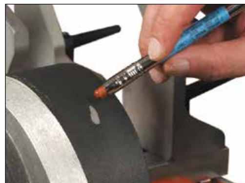
Temperaturkontroll med temperaturpenn
