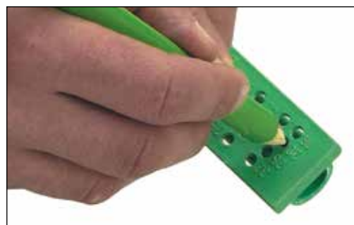
Markering av fusjonsdybde
