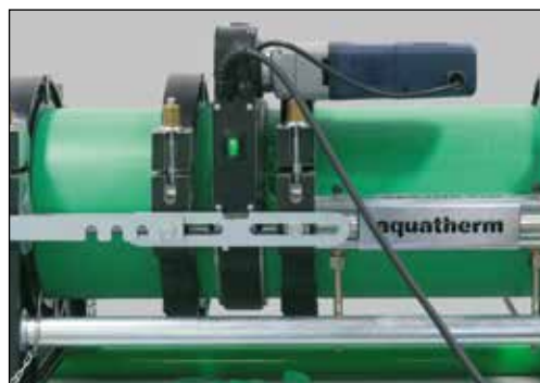
Rørendene høvles plane
