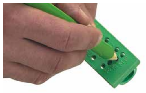
Markering av fusjonsdybde
