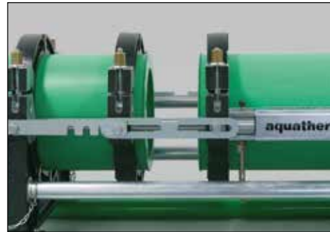
Separer maskinsleidene og fjern varmesverdet
