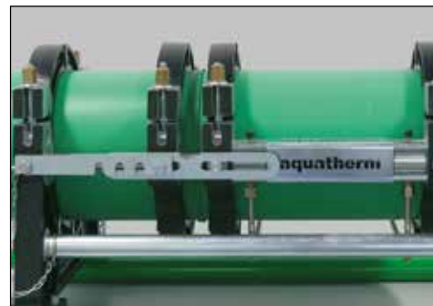
Trekk sammen rørene. La kjøle under trykk
