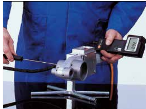
Temperaturkontroll med måleinstrument
