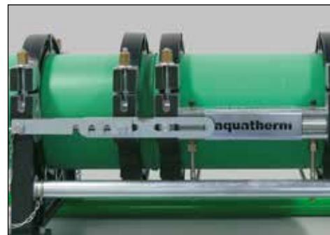
Trekk sammen rørene. La kjøle under trykk
