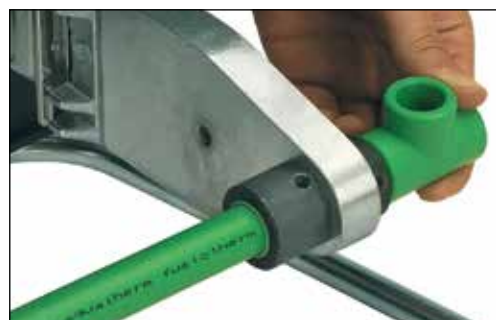
Oppvarming av rørdel
