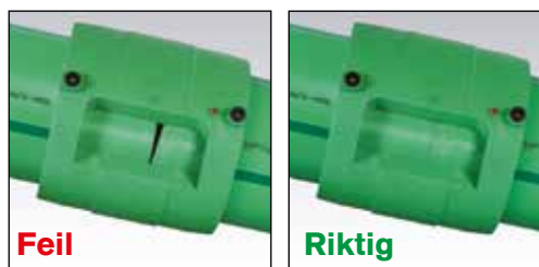
Begge rørene må ligge i rett linje for at optimal sveiseskjøt skal oppnås
