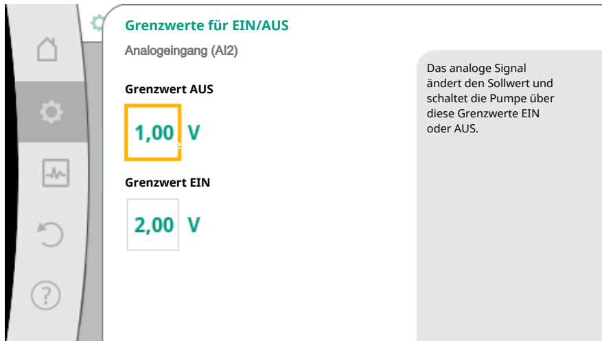
Fig. 74: Grenzwerte zur EIN/AUS-Steuerung über Analogsignale
