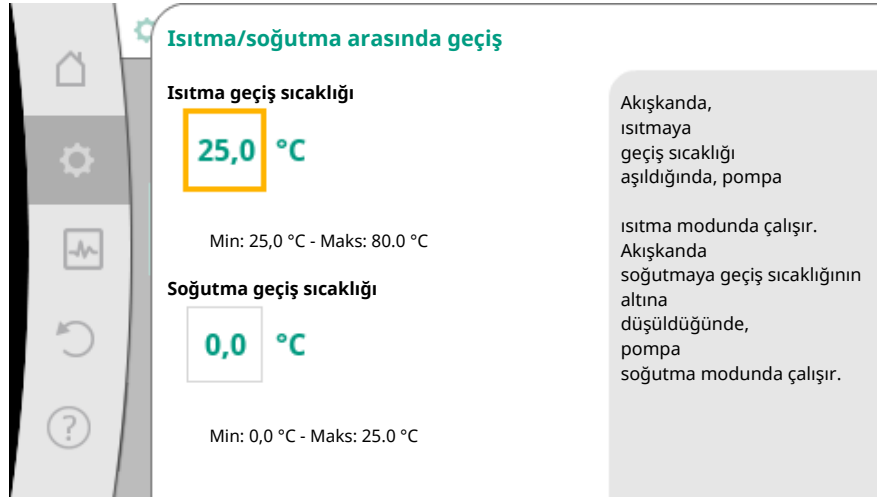
Fig. 57: Isıtma/soğutma_geçiş_sıcaklıkları arasında geçiş
