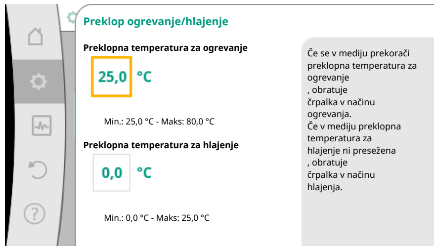
Fig. 57: Preklop ogrevanje/hlajenje_preklopne temperature
