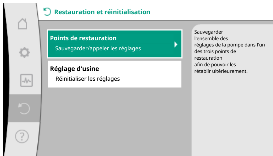
Fig. 85: Points de restauration
