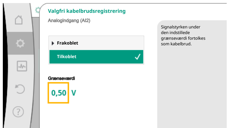
Fig. 72: Grænseværdi for kabelbrud
