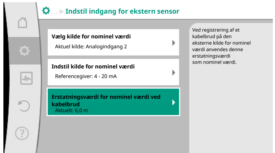
Fig. 77: Erstatningsværdi for nominal værdi ved kabelbrud
