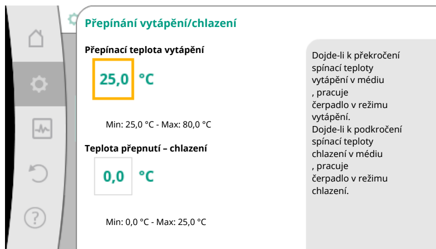
Fig. 57: Přepínání vytápění/chlazení_ teploty přepnutí
