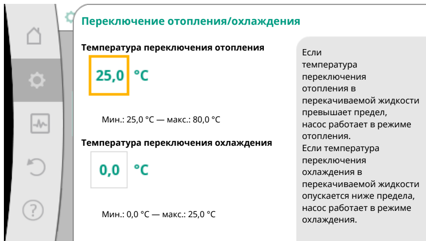
Fig. 57: Переключение отопления/охлаждения_Температуры переключения
