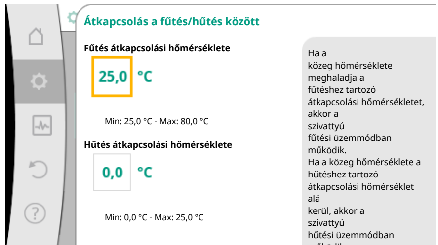
Fig. 57: Átkapcsolás a fűtés/hűtés között_Átkapcsolási hőmérsékletek
