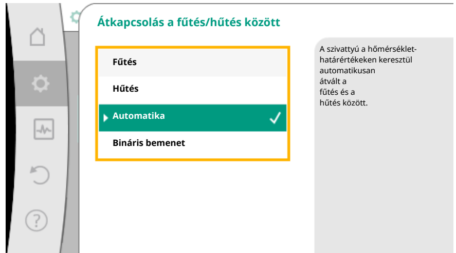
Fig. 56: Átkapcsolás a fűtés/hűtés között_Automatika
