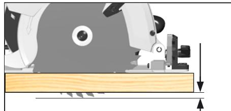
Głębokość cięcia należy dopasować do grubości obrabianego przedmiotu. Powinno być widoczne mniej jak pełna wysokość zębów pod obrabianym przedmiotem.
