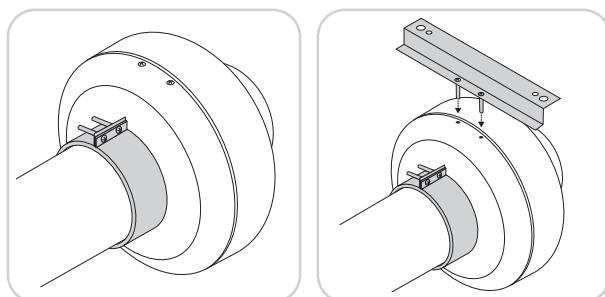
Asentaminen käyttää asennussankaa ja -kiinnikettä (lisävaruste).
