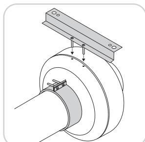
Montering med monteringsklämma och -beslag (tillbehör).
