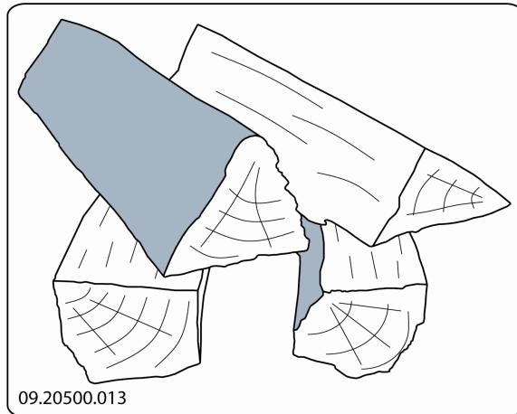
Ved løst ilegg forbrenner veden raskt fordi det letttere kommer oksygen til hver treski. Bruk løst ilegg hvis du skal fyre en kort stund.
