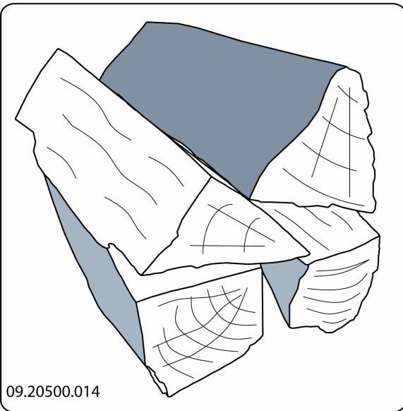
Ved kompakt ilegg forbrenner veden saktere fordi det kommer oksygen til bare noen av treskiene. Bruk kompakt ilegg hvis du skal fyre lengre.
