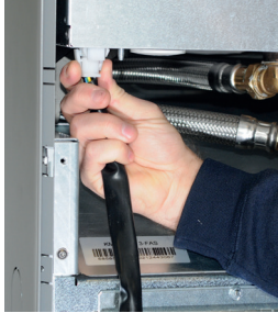
1. Lossa kylmodulens elkabelkontakt och slangar.
