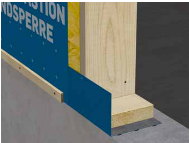
Fig. 23 Svillemembran med en leppe
