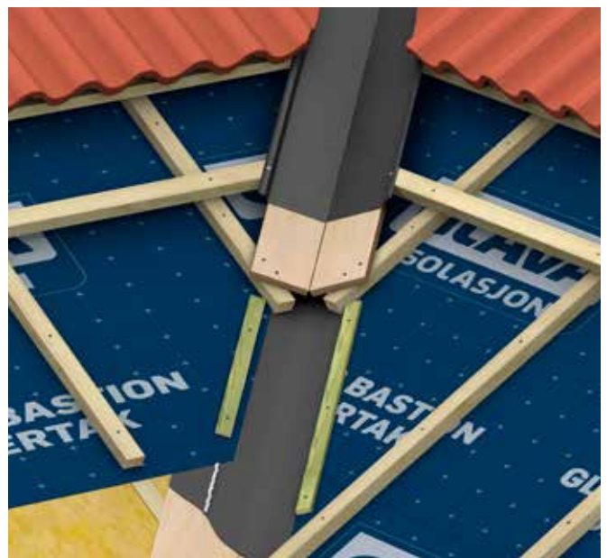
Fig. 19 Prinsipp for kilrenne med kilrennemembran
