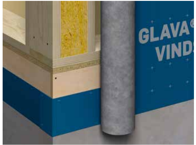
Fig. 28 Innfestet svillemembran før montering av vindsperre
