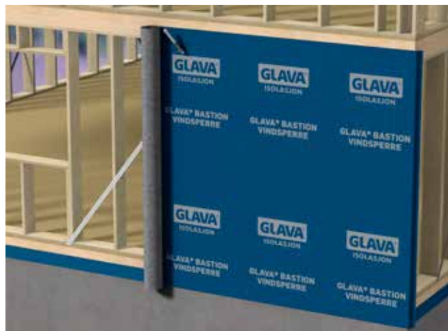
Fig. 34 Montering av etasjehøy vindsperre
