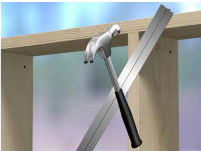
Fig. 31 Avstivningsstag bankes inn i slissen
