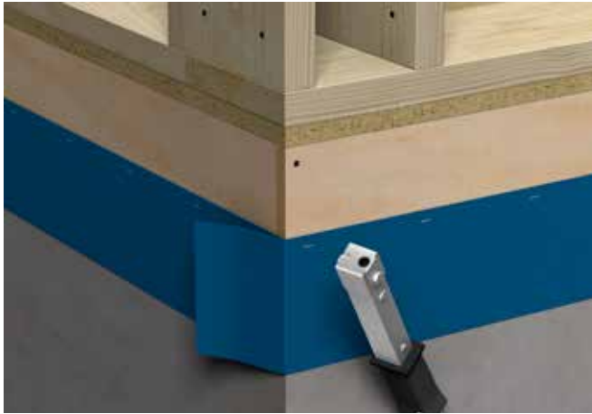
Fig. 27 Innfesting av svillemembran i hjørne
