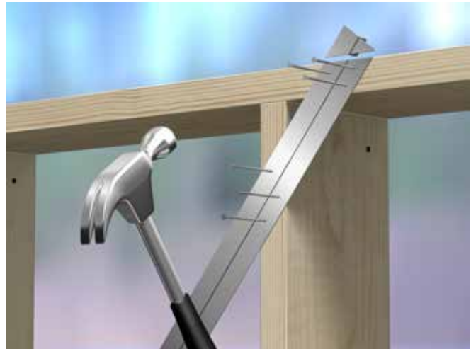
Fig. 32 Spikring av avstivningsstag
