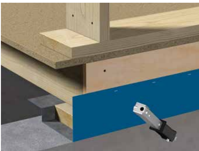
Fig. 24 Svillemembran med to lepper
