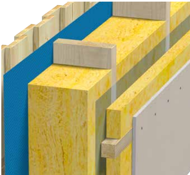
Fig.40 Yttervegg med inntrukket dampsperre
