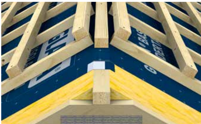
Fig. 17 Prinsipp for avslutning i mønet
