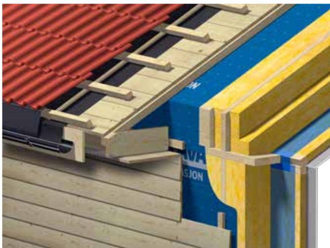
Fig. 33 Bastion vindsperre i takkonstruksjon med tradisjonelt lufteskikt
