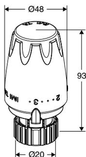
**Begrenset termostat med direktetilkobling til Danfoss RA ventildeler**
