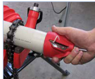
Fase enden av røret.
