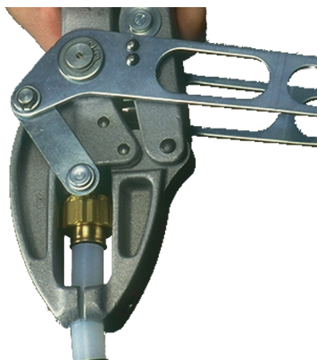
11. Kapp innerrørene og monter kplinger.
