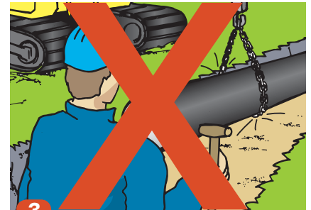
3 Unngå direkte kontakt mellom rør, kroker, kjeder eller metallwirer.
