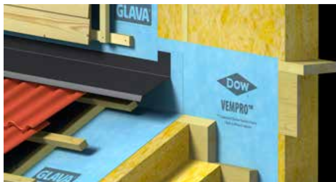
Fig. 18 Avslutning mot oppbygg
