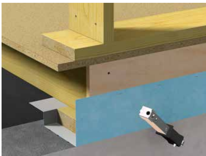
Fig. 24 Svillemembran med to lepper
