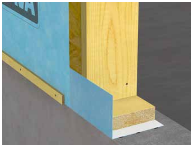
Fig. 23 Svillemembran med en leppe
