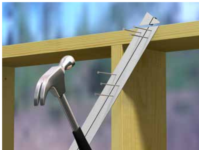
Fig. 32 Spikring av avstivningsstag
