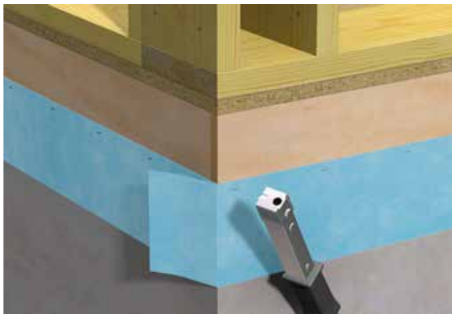
Fig. 27 Innfesting av svillemembran i hjørne
