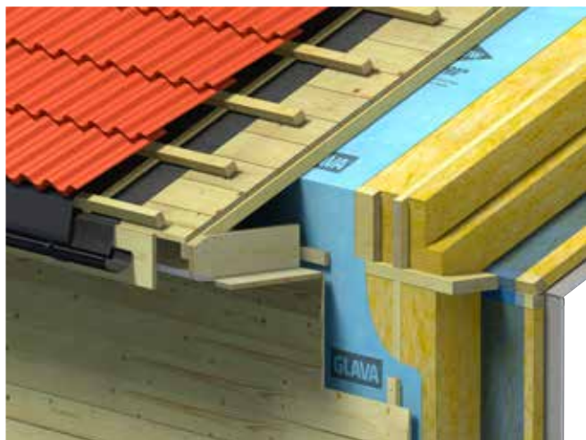
Fig. 33 Vempro™ Vindsperre i takkonstruksjon med tradisjonelt lufteskikt
