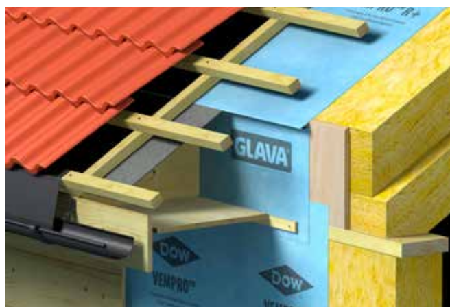
Fig. 15 Prinsipp for løse takutstikk
